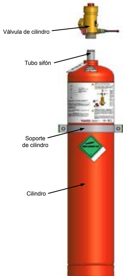
**Válvula de cilindro:** El disparo automático del líquido Novec 1230 lo controla una válvula de cilindro de latón forjado, que funciona por presión diferencial, conectada al cuello del cilindro. El conjunto de válvulas se suministra con un tapón de seguridad anti-retroceso instalado en la salida de descarga y encadenado a la válvula de cilindro.
