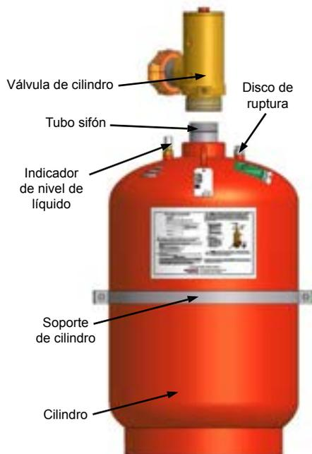
**Válvula de cilindro:** El disparo automático de FM-200® lo controla una válvula de cilindro de latón forjado, que funciona por presión diferencial, conectada al cuello del cilindro. El conjunto de válvulas se suministra con un dispositivo de seguridad anti-retroceso instalado en la salida de descarga y encadenado a la válvula de cilindro.
